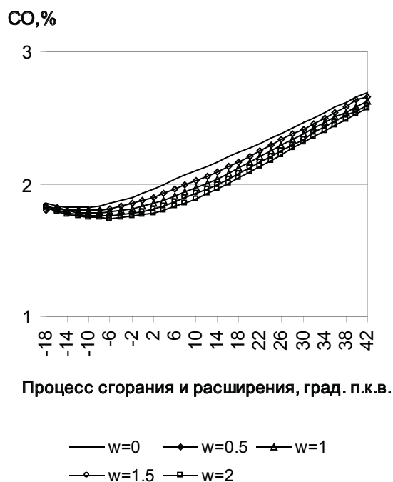
Рис. 1. Теоретические и экспериментальные данные содержания оксида углерода в ОГ дизеля при впрыскивании воды на режиме максимального крутящего момента
