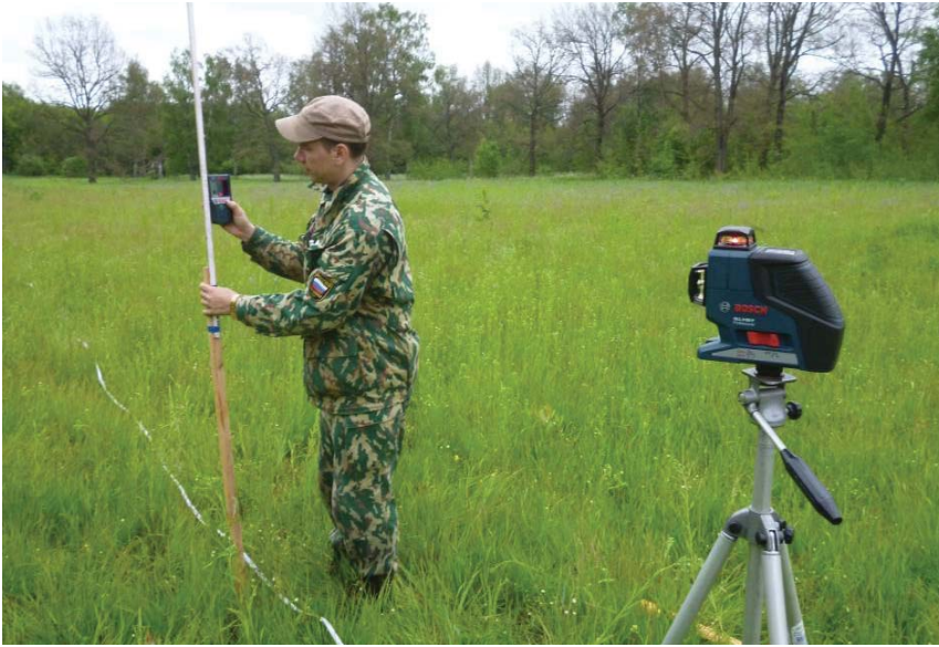
Рис. 1. Момент проведения замера. У исследователя в руках мерная линейка и приемник сигнала от лазерного нивелира
