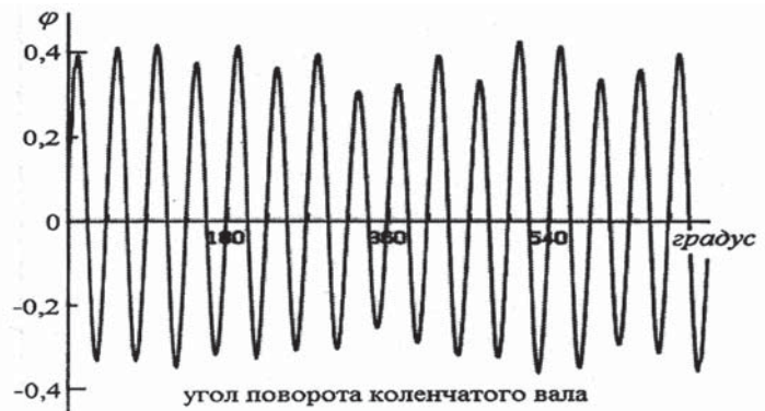
Рис. 5. Одноцикловая временная диаграмма угла закрутки носка коленчатого вала при n = 1900 мин -1 без демпфера крутильных колебаний
